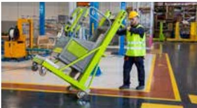
La fabricación en aluminio de la cesta, del mástil y del chasis, junto a la posibilidad de desmontar los contrapesos, permiten un manejo sencillo de productos con peso reducido.
