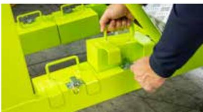
Los 4 contrapesos reducen el centro de gravedad de la plataforma durante el trabajo y están equipados con un sistema de desmontaje rápido, que permite reducir el peso durante el transporte.
