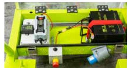
El escalón de acceso está fabricado con chapa de aluminio de alta resistencia. Contiene la batería de gel, el cargador de batería integrado, el interruptor principal y de emergencia y un botón para descender la jaula.
